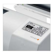
18 ComTouchTM-Tasten stehen frei programmierbar für die regelmäßig verwendeten Postprodukte zur Verfügung.
